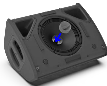
Une fois la grille retirée, un pavillon magnétique optionnel peut rapidement être installé de manière à changer la directivité pour passer de 100° x 100° à 110° x 60°
